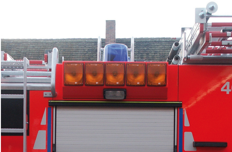
Abb. 6 Beispiel für ein Fahrzeug- Heckwarnsystem mit 5 Blinkleuchten
