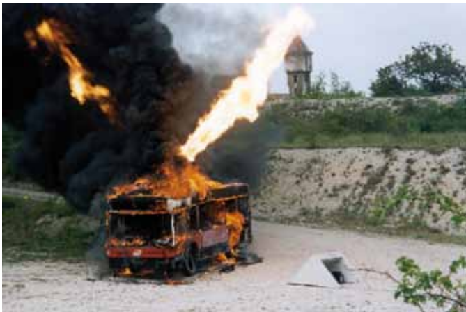
Sicherheitsventil spricht an, Flüssiggas entzündet sich und strömt in eine festgelegte Richtung ab
