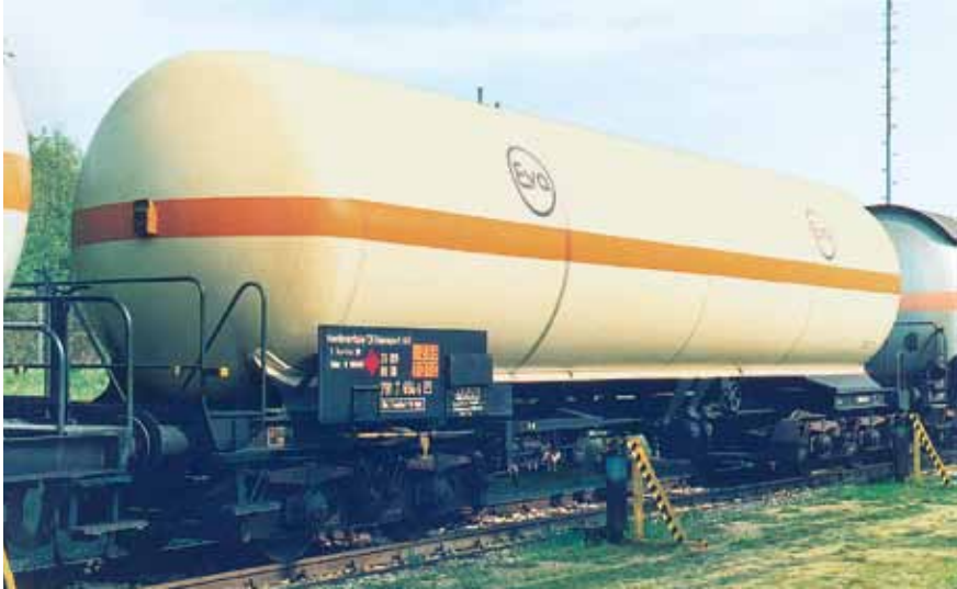
Eisenbahnkesselwagen mit orangenem Streifen in der Höhe der Behälterachse
