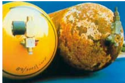
Bild 16: Flaschen(ventile) vor und nach der Flammeneinwirkung
