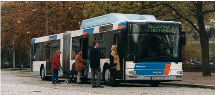
Bild 14: Erdgasbehälter auf dem Fahrzeugdach eines Omnibusses
