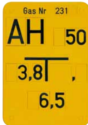
Bild 2: Hinweisschild für Absperrorgan einer Gasverteilungsleitung
