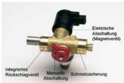
Bild 15: Aufbau eines Flaschenventils
